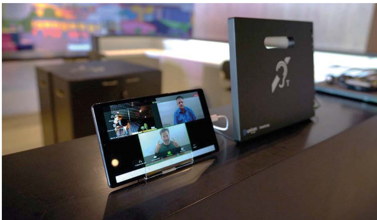
Fot. 2. Stanowisko recepcyjne wyposażone w pętlę indukcyjną oraz system do tłumaczenia na język migowy online, fot. M. Kuświk
